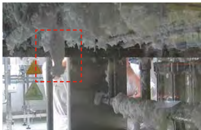
図8: レヒラーのPVDF製MicroWhirlyを使用した泡洗浄
