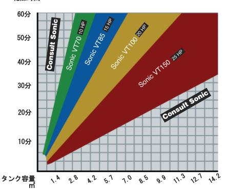
上記のデータにあるSonic DRY-IN-PLACE™システムは、 タンクの容量に応じて選択された一般的な機器を示しています。 各アプリケーションに必要な実際のモデルや大きさはSonicが 選定します。
